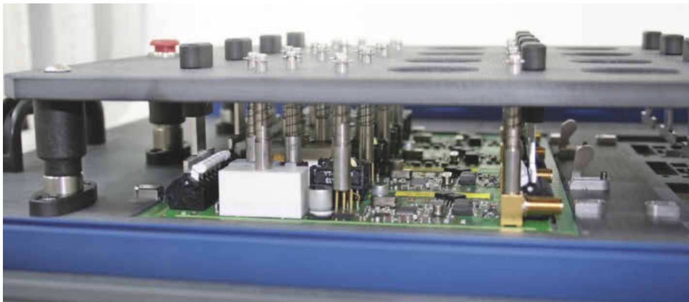
Ein typisches Projekt der SCS GmbH: Lötmaske mit Niederhaltedeckel zur Ausrichtung von THT-Bauteilen für den Wellenlötprozess.
