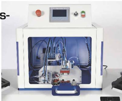
Eine Siemens SPS steuert und überwacht den Prozess sowie alle wichtigen Parameter.
