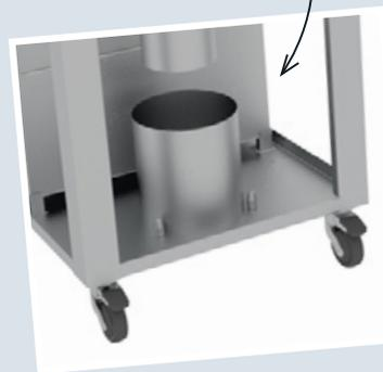
Der robuste Servicewagen aus Edelstahl ist ein praktischer Begleiter in Ihrer Fertigung. Er ermöglicht die notwendigen Wartungsarbeiten am Löttiegel und sorgt für den Transport des Betriebsmittels ohne Anstrengung.
