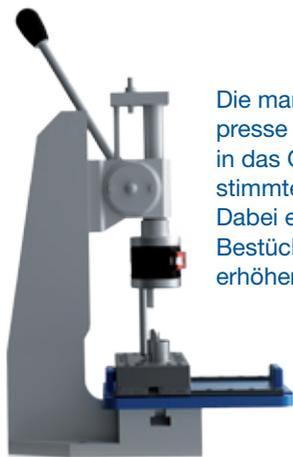
Die manuell bedienbare Zahnstangenpresse dient zur Montage einer Platine in das Gehäuse durch aufeinander abgestimmte Stempel- und Nestelemente. Dabei erleichtert ein Schlitten die Bestückung und Poka-Yoke-Lösungen erhöhen die Prozesssicherheit.
